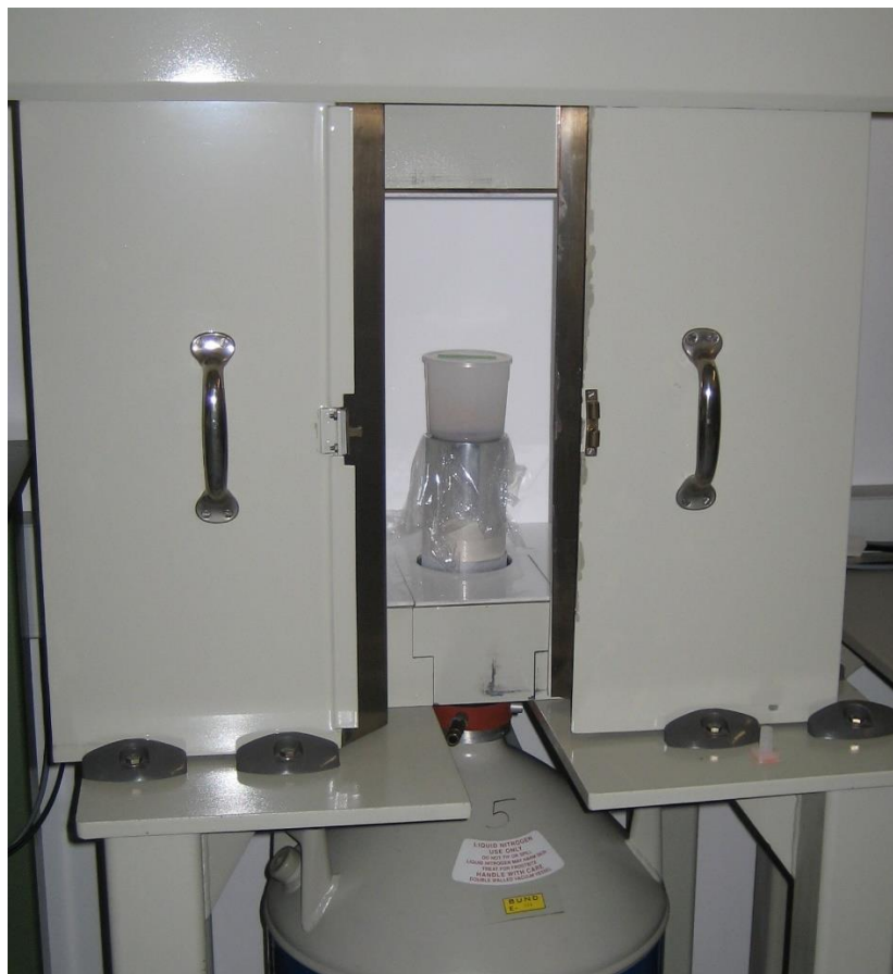
Abbildung 4: Reinstgermanium-Detektor mit getrockneter und gemahlener Pilzprobe für die gammaspektrometrische Messung von Cs-137.
