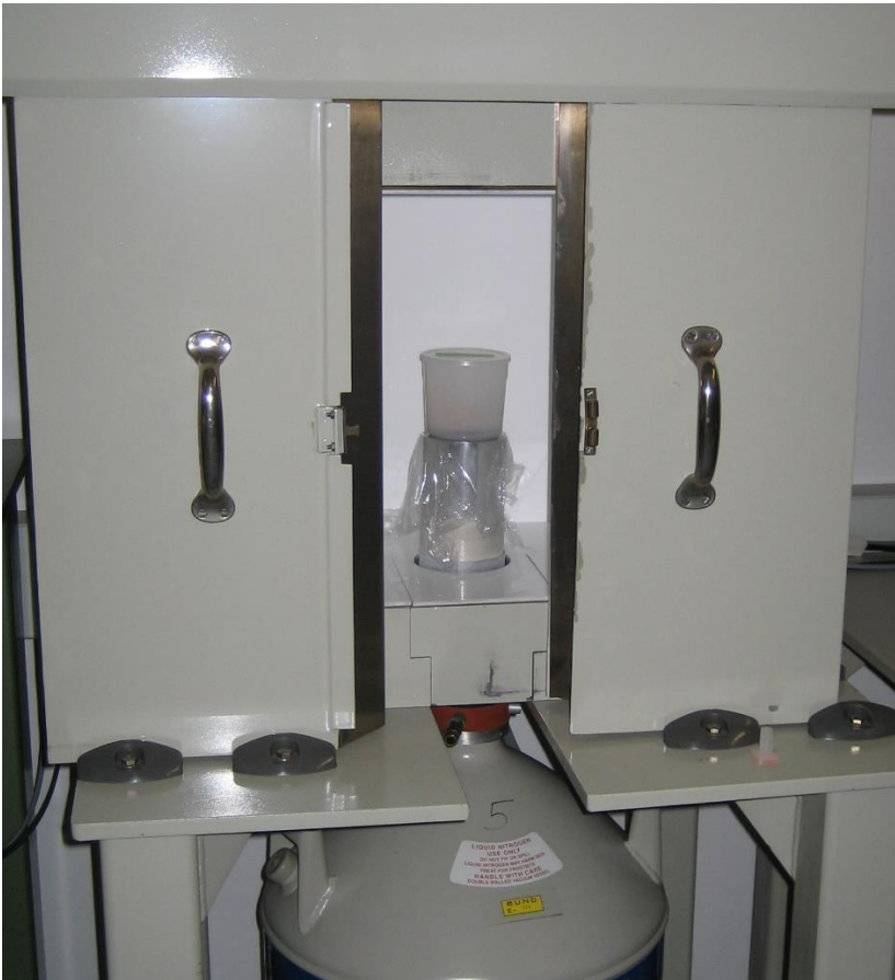
4 Reinstgermanium-Detektor mit getrockneter und gemahlener Pilzprobe für die gammaspektrometrische Messung von Cs-137.
